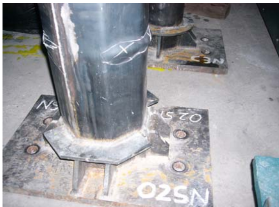
شکل ۳۴ شکست نمونه‌ی O2SN
