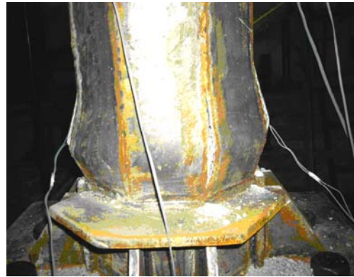
شکل ۲۶ شکست نمونه‌ی O3 در اثر کماتش موضعی جداری فولادی
