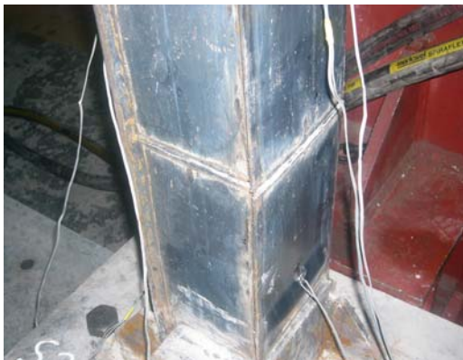
شکل ۲۸ شکست نمونه‌ی S2S
