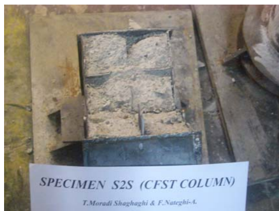
شکل ۲۹ شکست ورق‌های سخت کننده‌ی داخل نمونه‌ی S2S
