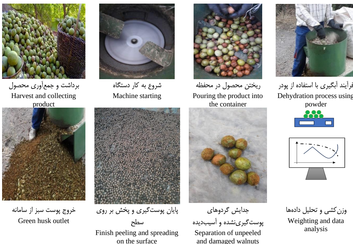
شکل ۳- مراحل انجام پژوهش برای پوست گیری، پوست سبز گردو در سرعت دورانی و عمق شیارهای مختلف Fig. 3. Research steps for peeling of walnut at various rotational speeds and groove depths
