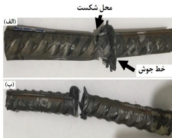
شکل ۲ شکست میلگردها: (الف) فلز پایه (نمونه S3) و (ب) جوش (نمونه S4) آزمون کشش
