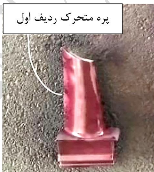
شکل ۲- نتایج آزمون مایع نافذ بر روی پره متحرک ردیف اول از جنس IN738LC در توربین گازی کلاس E مدل زمینس V94.2
