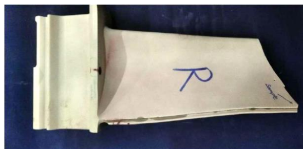
شکل ۱- تصاویر ظاهری از پره متحرک ردیف اول از جنس IN738LC در توربین گازی کلاس E مدل زمینس (V94.2 SGT5-2000E).
