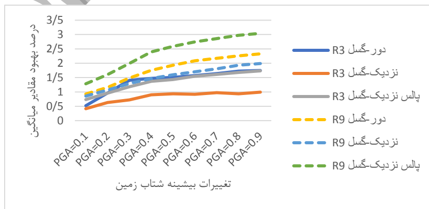
شکل ۱۲: ارزیابی اثر کنترل فازی در مقایسه با کنترل بهینه خطی بر بیشینه و جذر مجموع مربعات شتاب تحت تأثیر انواع زلزله در پریود ۱/۳ ثانیه
