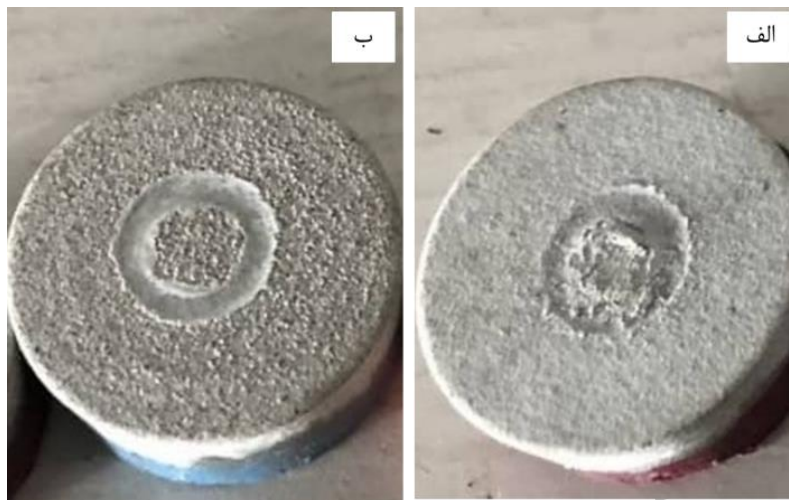
شکل (۱۱): تصویر سطح نمونه‌ها پس از انجام آزمون سایش تحت نیروی ۱۰ نیوتن، (الف) آلومینای میکرونی، (ب) کامپوزیت Al_2O_3 -20% Y_2O_3 میکرونی.
