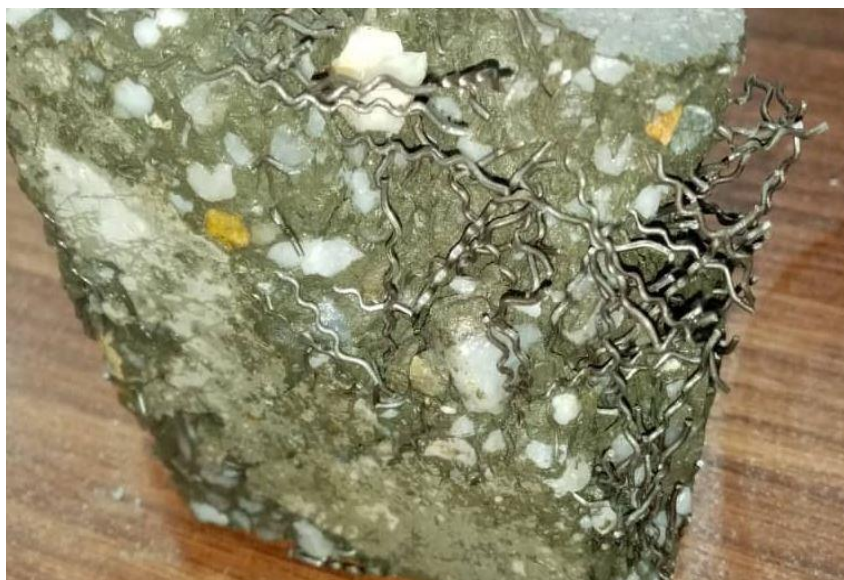
شکل ۲۲- توزیع نامتقارن الیاف فولادی در مقطع بتنی
