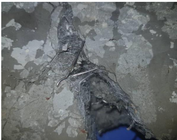
ب) جدا شدن الیاف فولادی از مقطع ترک و ادامه پل‌بندی مقطع توسط الیاف پلی‌پروپیلن
