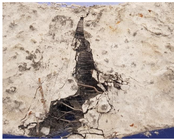
الف) توزیع پیوسته و پل‌بندی مناسب الیاف پلی‌پروپیلن در دهانه ترک
