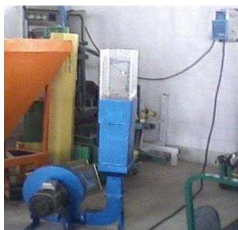
شکل ۲. تونل باد عمودی برای تعیین سرعت حد میوه زرشک، ۱- موتور الکتریکی و فن ۲- تنظیم کننده سرعت موتور ۳- بادسنج دیجیتال ۴- پخش کننده
