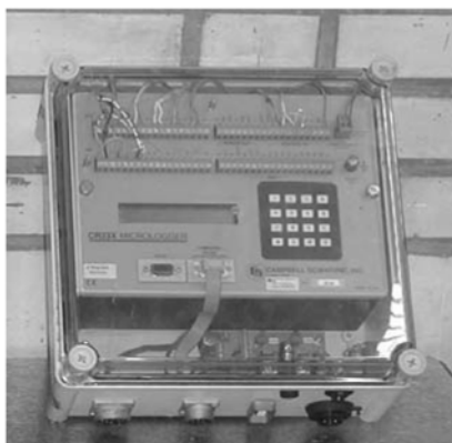
شکل 1- تراکتور مجهز به دینامومتر اتصال سه نقطه (راست) و دیتالاگر Campbell CR23X (چپ)
