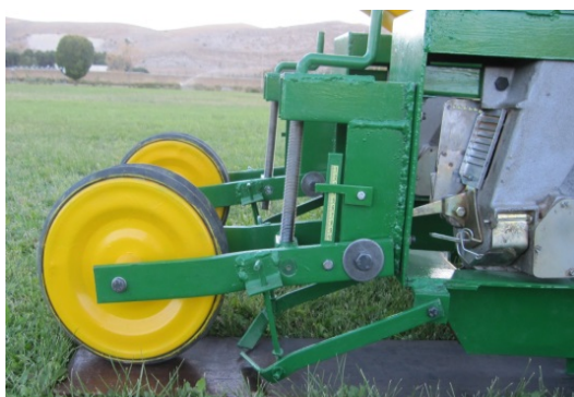
شکل ۴- نمایی از مکانیزم چرخ تنظیم عمق و فشار دهنده Fig. 4. The mechanism of depth wheel and packer wheel (side view)
