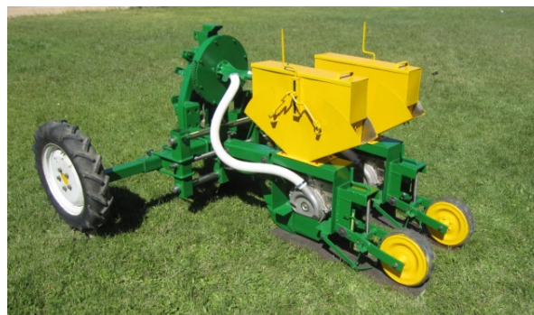
شکل ۷- مخزن‌های شیب متحرک سوار شده بر روی ماشین کشت مخلوط Fig. 7. Slop moveable seed hoppers mounted on intercropping machine
