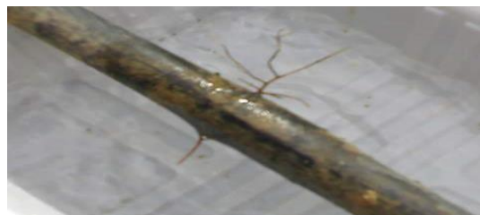
شکل ۲- نمونه‌ای از گرفتگی قطره‌چکان‌ها توسط ریشه درخت (توت و درختچه گل محمدی)
