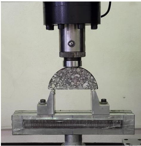
شکل ۴ نحوه قرارگیری نمونه در دستگاه یونیورسال
