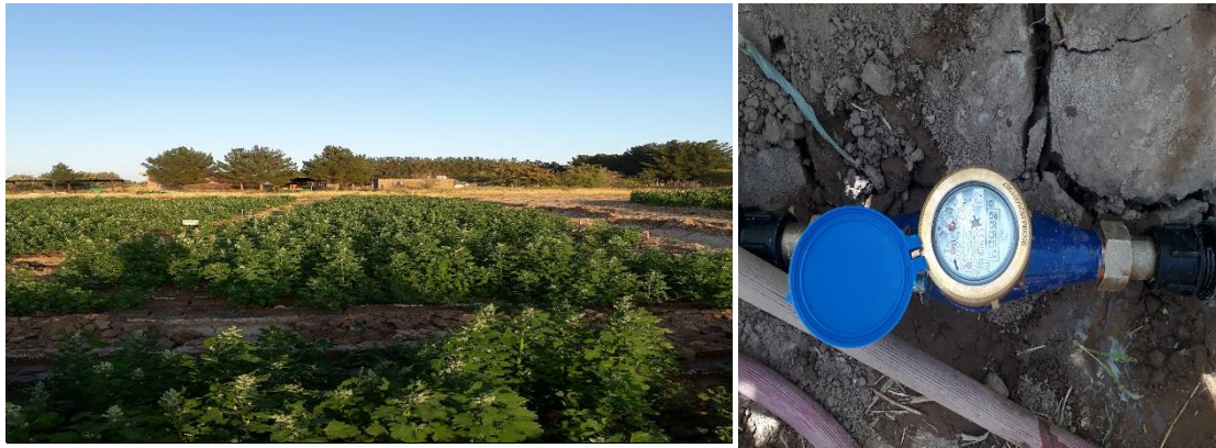
شکل ۱- مکان آزمایشی و کنتور آب برای اندازه‌گیری مصرف آب نصب شده است.
