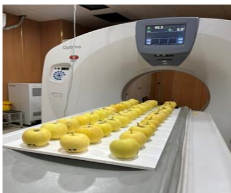
شکل ۱- تصویربرداری سیب با دستگاه سی تی اسکن
