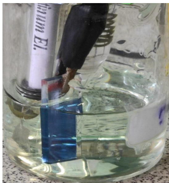
شکل ۲. تصویری از شیشه رسوب‌نشانی شده با فیلم اکسید تنگستن در حین فرایند رسوب‌نشانی.
