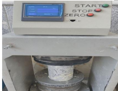
شکل ۷. آزمون مقاومت فشاری نمونه ها توسط جک
