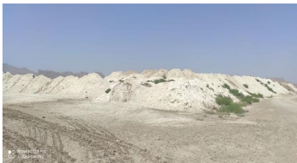
شکل ۲. انباشت کیک کربناته، ضایعات کارخانه قند در حیاط و محوطه بیرونی کارخانجات
