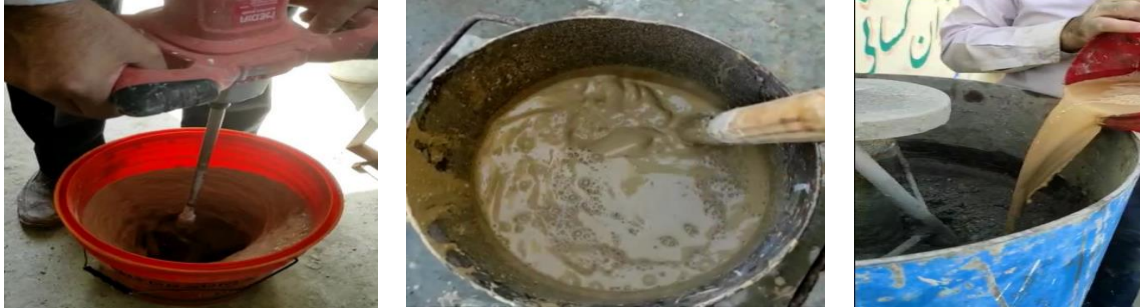
شکل ۵. حل کردن کیک کربناته در آب طرح اختلاط به دو روش دستی و همزن برقی و افزودن به مخلوط
