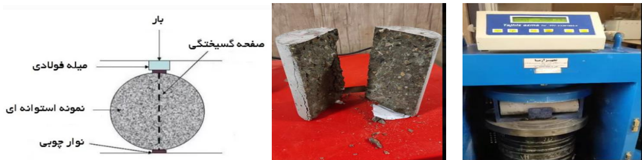
شکل ۸. آزمایش مقاومت کششی (تست برزیلی)
