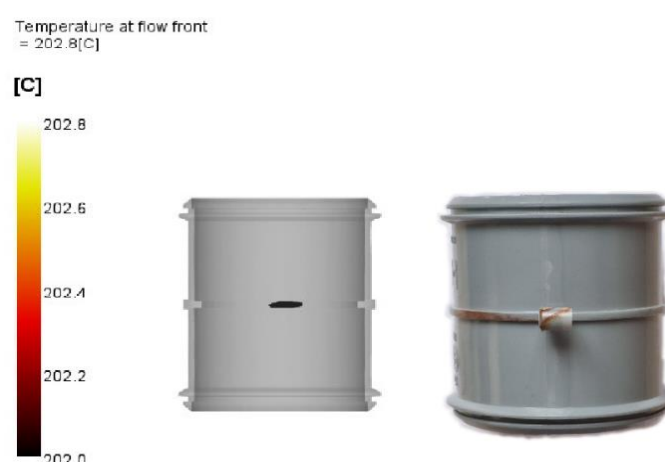
شکل ۱۲ عیب سوختگی در آزمایش ۲
