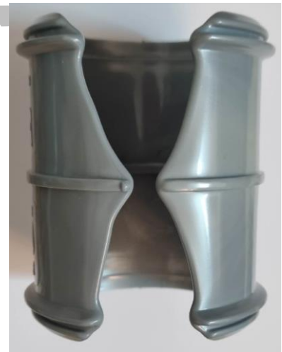
شکل ۱۰: عیب پرنشدهن قالب (الف و ب) نحوه پرشدن مذاب در قالب به صورت تجربی و (ج) الگو پرشدن مذاب در شبیه‌سازی
