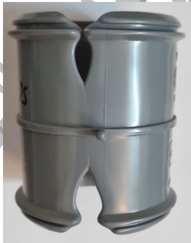
شکل ۱۰: عیب پرنشدهن قالب (الف و ب) نحوه پرشدن مذاب در قالب به صورت تجربی و (ج) الگو پرشدن مذاب در شبیه‌سازی
