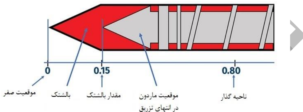
شکل ۸: بالشتک در فرایند تزریق
