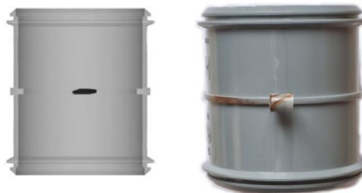
شکل ۱۲: عیب سوختگی در آزمایش ۲
