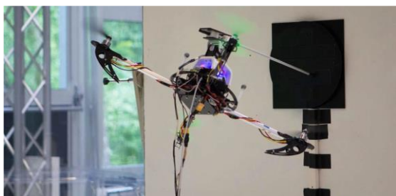
شکل ۳: پهپاد مجهز به بازوی یک درجه آزادی اولایی [۴]
