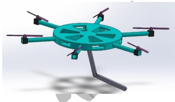
شکل ۶: پیکربندی هگزاروتور مجهز به بازو
