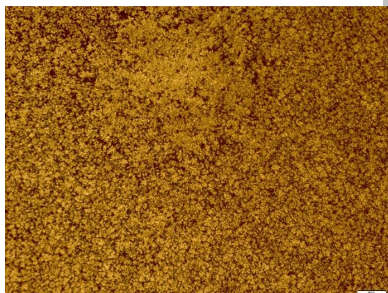
شکل ۳: تصویر میکروسکوپ نوری از نمونه اکستروژن شده Al5083-5wt% ZrB 2
