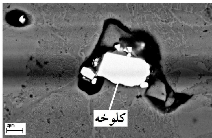
شکل ۷- تصویر میکروسکوپ الکترونی روبشی از نمونه فولادی حاوی ۴ درصد وزنی کاربید تنگستن که نمایش‌دهنده کلوخه‌ای شدن ذرات تقویت‌کننده در زمینه فولادی است.
